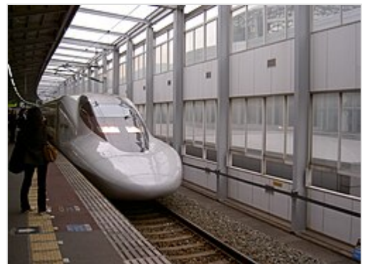
Shinkansen 700 (in Kyoto) mit optimierter Nase gegen den Tunnelknall
